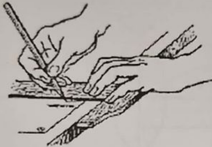
شکل رسم درست خط با استفاده از خط‌کش تی
