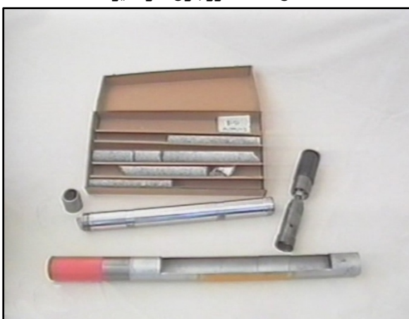
شکل ۲-۱۲ جعبه نگهداری مغزه های سنگی
