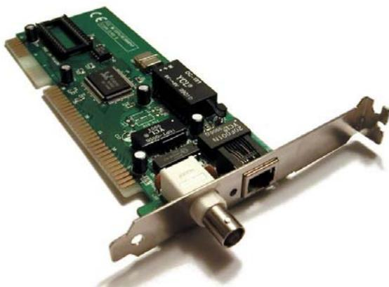
شکل روپرتو یک کارت شبکه را نشان می‌دهد. کارتهای شبکه در ابتدا فقط کانکتور BNC داشتند و فقط در شبکه‌های Bus استفاده می‌شدند. کارتهای امروزی فقط کانکتور RJ45 دارند. کارتهای اولیه دارای کانکتور RJ45، دارای سرعت 10 mb/s بودند ولی کارتهای امروزی دارای سرعت 1 Gb/s هستند.
