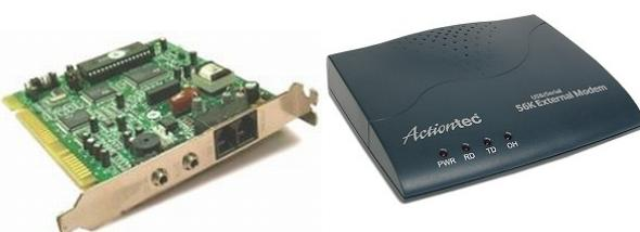
مودم نشان داده شده در شکل چپ یک مودم است، پورتهای مربوط به میکروفون و Speaker بروی آن مشاهده می‌شود. این کارتها برای نرم افزارهایی مثل منشی تلفنی بسیار مورد استفاده قرار می‌گیرد. شکل روبرو نمونه یک مودم external را نشان می‌دهد که ممکن است به پورت سریال یا به پورت USB متصل شود.
