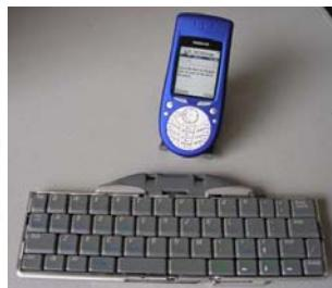
تمایل به استفاده از صفحه کلیدهای بدون سیم امروزه بسیار افزایش پیدا کرده شکل سمت چپ صفحه کلید و ماوس بدون سیم را نشان می‌دهد و شکل سمت راست یک صفحه کلید بی سیم دارای فناوری بلوتوث را نشان داده است که قابلیت ارتباط با دستگاههای تلفن همراه مجهز به این فناوری را دارد.
