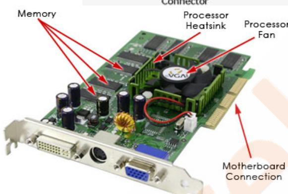
شکل رویرو یک کارت گرافیک را نمایش می‌دهد. تنوع کارت های موجود در نوع اسلات آنها ، نوع پورتهای خروجی آنها و میزان حافظه موجود بر روی این کارت ها است. کارت های گرافیک امروزه به صورت PCI و AGP موجود هستند. سرعت گذرگاه اسلات AGP از PCI بیشتر است. کارت های گرافیک بایستی حداقل، پورت مربوط به خروجی مانیتور را داشته باشد و علاوه بر آن می توانند پورتهای ویدئوی آنالوگ و یا svideo هم داشته باشند. میزان حافظه کارت هرچه بیشتر باشد سرعت آن بیشتر و کیفیت رنگ و وضوح صفحه تصویر بیشتر خواهد بود.
