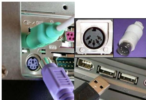
در شکل روبرو انواع پورتهای صفحه کلید نمایش داده شده است، شکل سمت راست بالا یک پورت AT را به همراه مبدل «PS2 به AT» به نشان می‌دهد. کامپیوترهای اولیه دارای این نوع پورت بودند از سری کامپیوترهای Pentium II که منبع تغذیه به ATX تبدیل شد پورتهای صفحه کلید به PS2 (آنچه در شکل سمت چپ آمده است) تبدیل شد. امروزه پورت USB بیشتر از پورت PS2 (آنچه در شکل سمت راست پایین آمده است) مورد استفاده قرار می‌گیرد.
