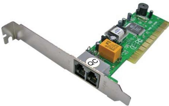
شکل روبرو یک کارت فاکس مودم را نشان می‌دهد که دارای دو درگاه به نامهای Line و Phone است که باستی به خط تلفن متصل شود در صورتی که بخواهید همزمان از یک پریز برای کامپیوتر و تلفن استفاده کنید می‌توانید تلفن را به درگاه Phone متصل کنید.
