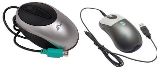
بعداً کلید وسط ماوس، تبدیل به یک استوانه چرخنده شد که کاربرد وسیع آن در مشاهده صفحات وب است، ضمن اینکه سریهای بعدی ماوس دارای پورتهای PS2 و USB بودند.
