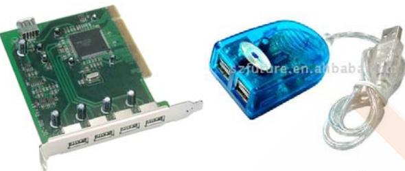
از مزایای پورت USB این است که به سادگی قابل گسترش است این کار توسط هاب USB انجام می‌شود که به صورت internal و external مطابق آنچه در شکل روبرو آمده است وجود دارد.
