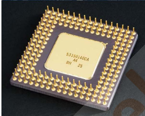
شکل روپرو یک پردازنده پنتیوم را نشان می‌دهد. پردازنده، مغز متفکر کامپیوتر است و جزء اجزاء اصلی کامپیوتر محسوب می‌شود. در هنگام نصب آن باید دقیق بسیار باید تا پایه‌های آن خم نشود و دست زدن به پایه‌های آن ممکن است باعث تخلیه ناگهانی بار الکترونیکی و در نتیجه سوختن آن شود. تنوع پردازندگان بیشتر در میزان سرعت آنها (Cache) فرکانس نمایش داده می‌شود و میزان حافظه پنهان آنها است. البته خانواده و نسل آنها ملاک اصلی به شمار می‌رود.
