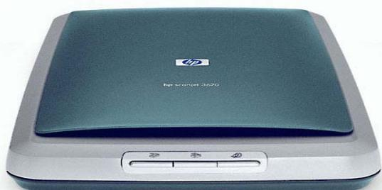
انواع رومیزی اسکنر به صورت معمولی و حرفه‌ای است. در نوع معمولی آن، کاغذ توسط کاربر بر روی صفحه گذاشته می‌شود و اسکنر با حرکت دادن منبع نور و سنسور در زیر صفحه آن را می‌خواند، اما در نوع حرفه‌ای یک جایگاه مخصوص کاغذ در آن تعییه شده و اسکنر به طور خودکار کاغذها را به داخل محفظه خود می‌کشد.
