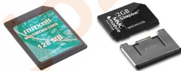
کارت‌های حافظه بسیار کوچکی به ابعاد مختلف نیز تولید شده اند که در دستگاههایی چون دوربینهای دیجیتال، MP3 playerها و گوشی‌های موبایل بکار می‌روند و با استفاده از یک دستگاه کارت‌خوان (RAM Reader) ارزان قیمت، قابل اتصال به کامپیوتر هستند.
