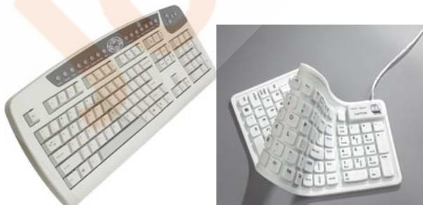
شکل روبرو دو مدل صفحه کلید را نشان می‌دهد. مدل اول، یک صفحه کلید معمولی و مدل دوم، یک صفحه کلید قلب قبل انعطاف است که معمولاً برای Laptop ها مورد استفاده قرار می‌گیرد.
