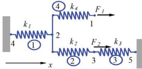
برای سیستم فنرهای نشان داده شده، ماتریس سختی سراسری را تعیین کنید.
