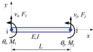
با استفاده از معادلات شیب - افت می توان ماتریس سختی المان تیر را تعیین نمود.
