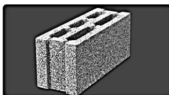
دیواری توخالی ته پر (سه جداره) Size: 49×14.5×20 Max. Weight: 10.7 kg Sound Resistance: 49 db
