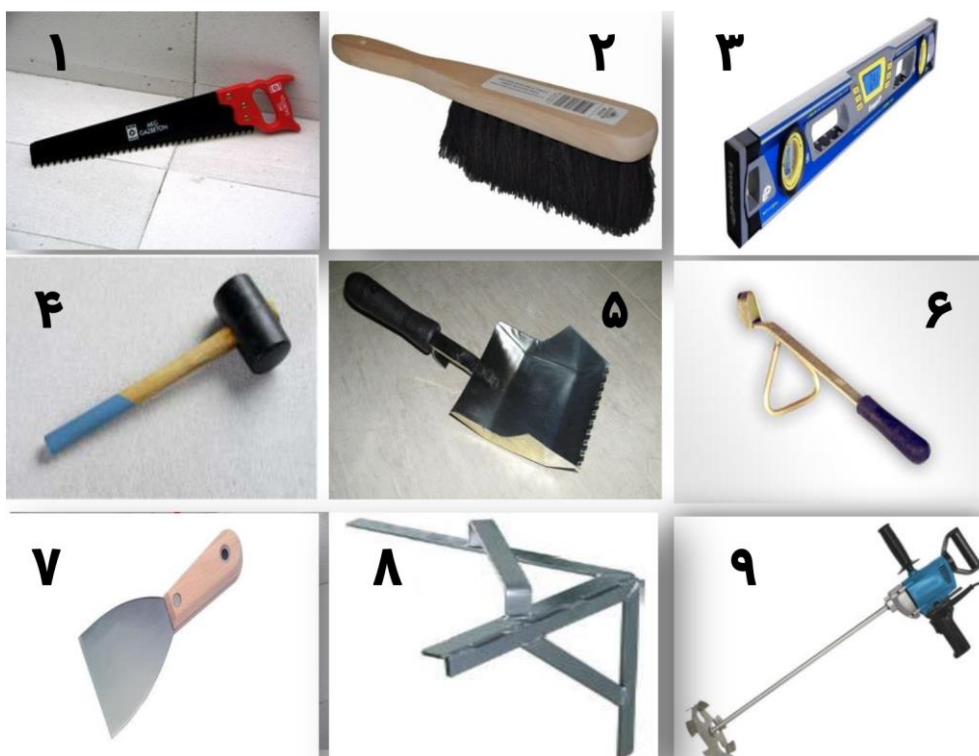
شکل (۱۳-۵): وسایل مورد نیاز جهت دیوار چینی با استفاده از بلوک هبلکس
